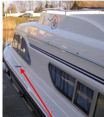
Emplacement réservoir Water tank Wassertank
