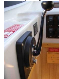
Fig 1 Mise au neutre Neutral position Neutral Position
