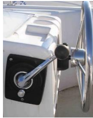
Fig 1 Mise au neutre Neutral position Neutral Position
