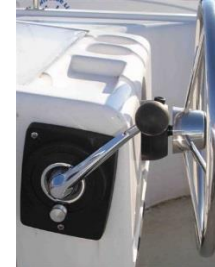
Fig 1 Mise au neutre Neutral position Neutral Position
