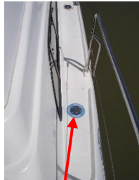
Emplacement réservoir Water tank Wassertank
