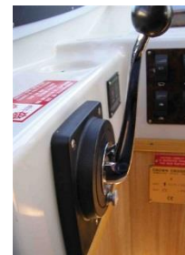
Fig 1 Mise au neutre Neutral position Neutral Position
