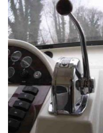
Fig 1 Mise au neutre Neutral position Neutral Position
