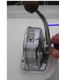
Fig 2 Hélice désengagée Disengaged drive Schraube auskuppeln
