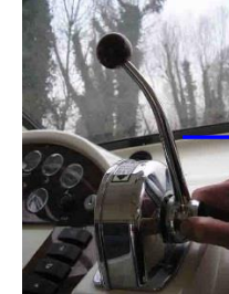
Fig 2 Hélice désengagée Disengaged drive Schraube auskuppeln
