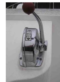
Fig 1 Mise au neutre Neutral position Neutral Position
