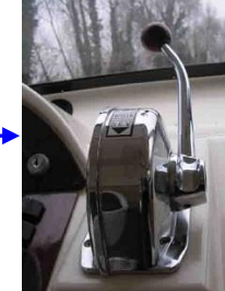
Fig 2 Hélice désengagée Disengaged drive Schraube auskuppeln
