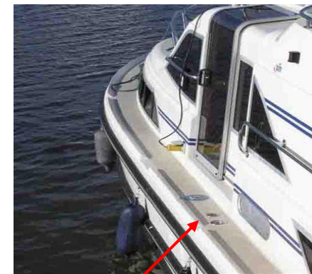
Emplacement réservoir Water tank Wassertank
