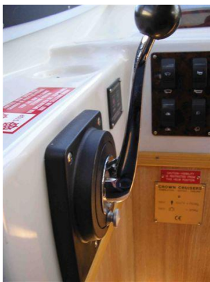
Fig 1 Mise au neutre Neutral position Neutral Position
