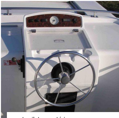
poste pilotage extérieur exterior steering position Aussensteuerstand
