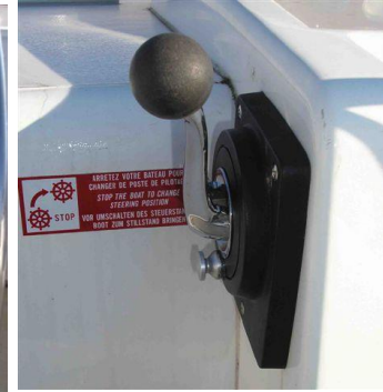
Fig 2 Hélice désengagée Disengaged drive Schraube auskuppeln
