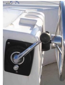
Fig 1 Mise au neutre Neutral position Neutral Position
