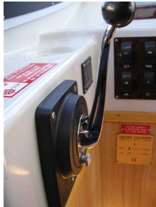
Fig 2 Hélice désengagée Disengaged drive Schraube auskuppeln
