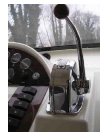
Fig 1 Mise au neutre Neutral position Neutral Position
