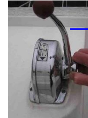
Fig 2 Hélice désengagée Disengaged drive Schraube auskuppeln
