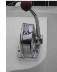
Fig 1 Mise au neutre Neutral position Neutral Position
