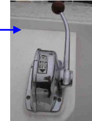
Fig 2 Hélice désengagée Disengaged drive Schraube auskuppeln
