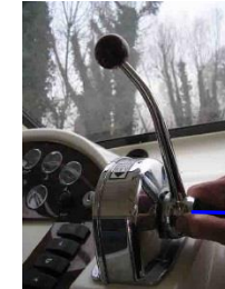
Fig 2 Hélice désengagée Disengaged drive Schraube auskuppeln
