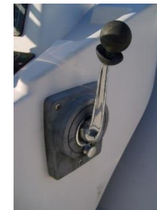
Fig 1 Mise au neutre Neutral position Neutral Position
