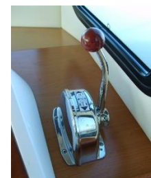
Fig 1 Mise au neutre Neutral position Neutral Position
