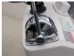
Fig 1 Mise au neutre Neutral position Neutrale Position
