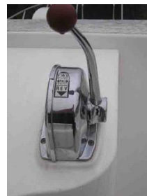
Fig 1 Mise au neutre Neutral position Neutral Position
