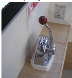
Fig 1 Mise au neutre Neutral position Neutral Position
