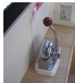
Fig 1 Mise au neutre Neutral position Neutral Position
