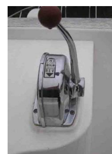
Fig 1 Mise au neutre Neutral position Neutral Position
