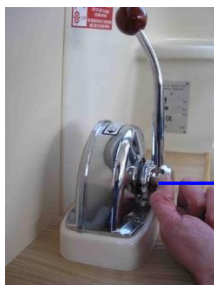
Fig 2 Hélice désengagée Disengaged drive Schraube auskuppeln
