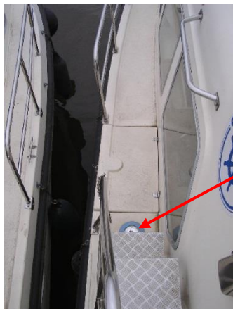
Emplacement réservoir Water tank Wassertank
