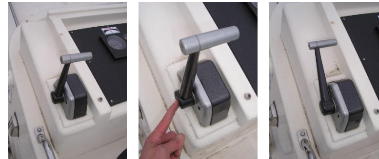
Fig 1 Mise au neutre Neutral position Neutral Position
