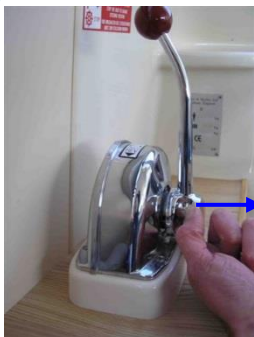
Fig 2 Hélice désengagée Disengaged drive Schraube auskuppeln
