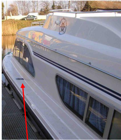
Emplacement réservoir Water tank Wassertank
