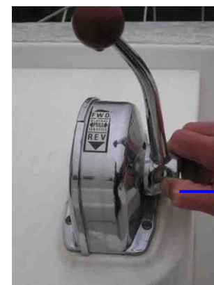
Fig 2 Hélice désengagée Disengaged drive Schraube auskuppeln
