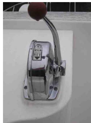
Fig 1 Mise au neutre Neutral position Neutral Position
