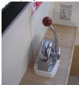
Fig 1 Mise au neutre Neutral position Neutral Position
