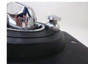
Hélice désengagée / Disengaged Drive-used for charging batteries/ Schraube auskuppeln
