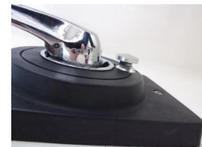
Hélice engagée / Engaged Drive/ Schraube in Betrieb
